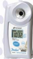
PAL-MILK SG Gravedad específica: 1.008~1.036
