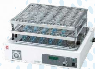
MK201D-115V Agitador de Tubos 20 ~ 200 rpm
